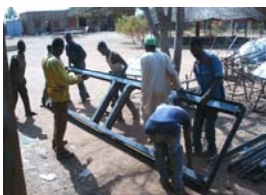
Fabrication d'un chassis d'une plateforme
